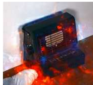
(写真) カセットボンベ式ガスストーブにボンベが正しく装着されずにガスが漏れ、点火した時に異常着火した様子（イメージ）
